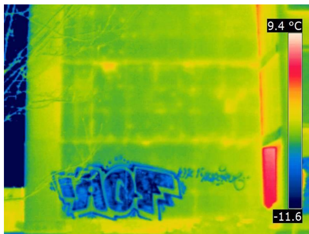
Obrázek 25: vliv emisivity na zdánlivou teplotu povrchu objektu (20)
