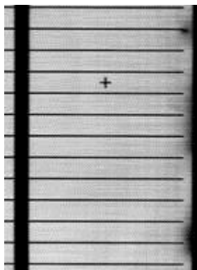
Obrázek 24: Příklad špatného obroušení hran solárního článku
