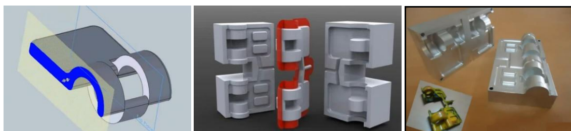
Obr. 17 Fáze výroby technologií RIM [11]
