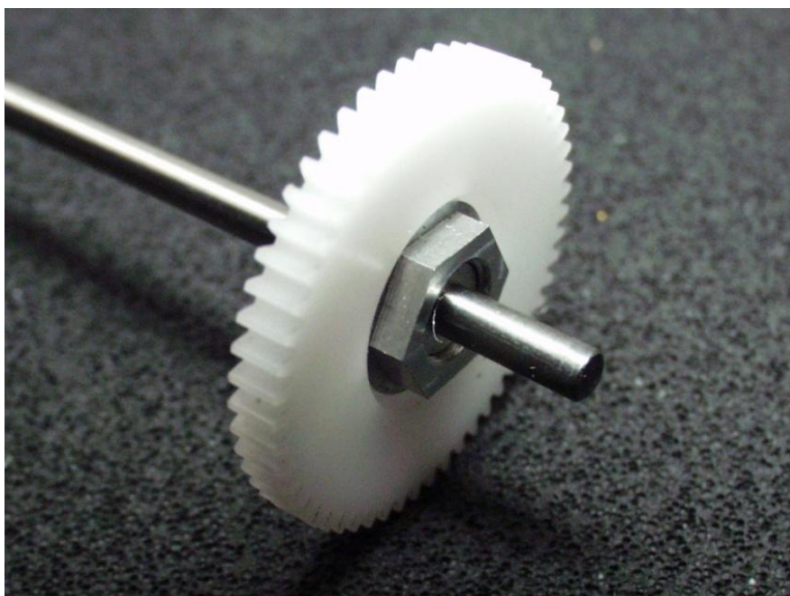
Obr. 8 Ukázka ozubeného kola z plastické hmoty[14]
