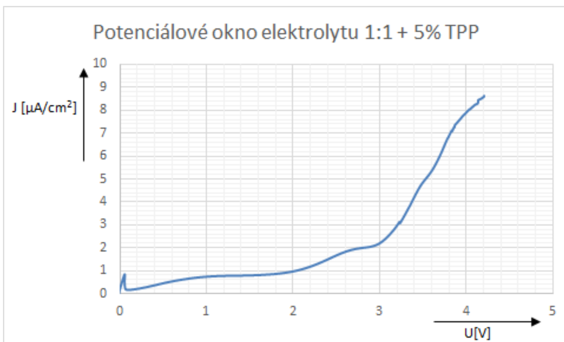
Obr. 6.21: Graf potenciálového okna vzorku 1:1 s 5% retardéru hoření TPP.
