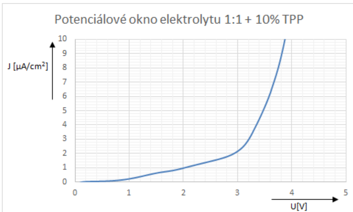
Obr. 6.24: Graf potenciálového okna vzorku 1:1 s 10% retardéru hoření TPP.
