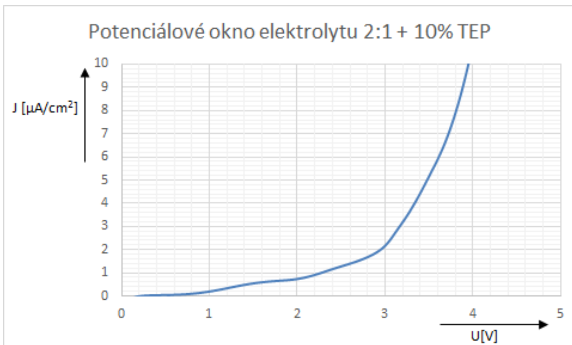
Obr. 6.20: Graf potenciálového okna vzorku 2:1 s 10% retardéru hoření TEP.
