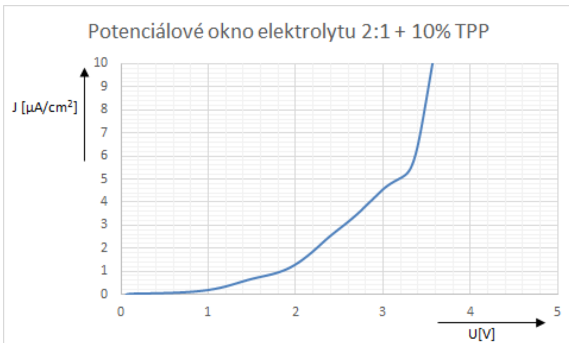
Obr. 6.26: Graf potenciálového okna vzorku 2:1 s 10% retardéru hoření TPP.
