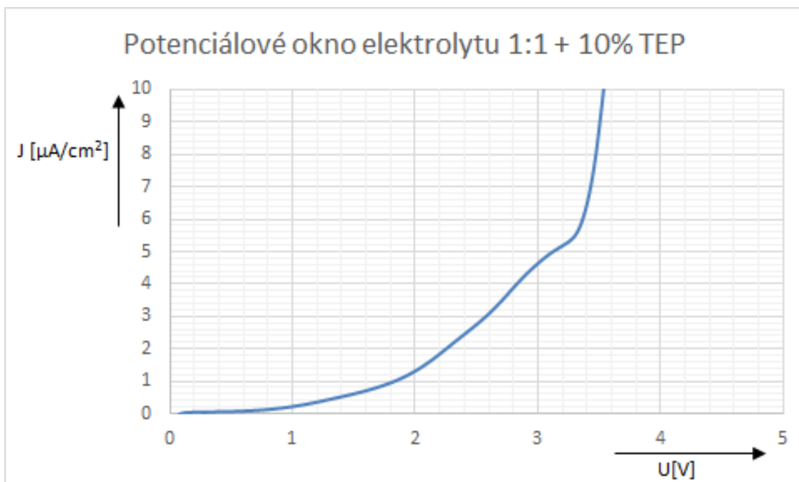
Obr. 6.18: Graf potenciálového okna vzorku 1:1 s 10% retardéru hoření TEP.
