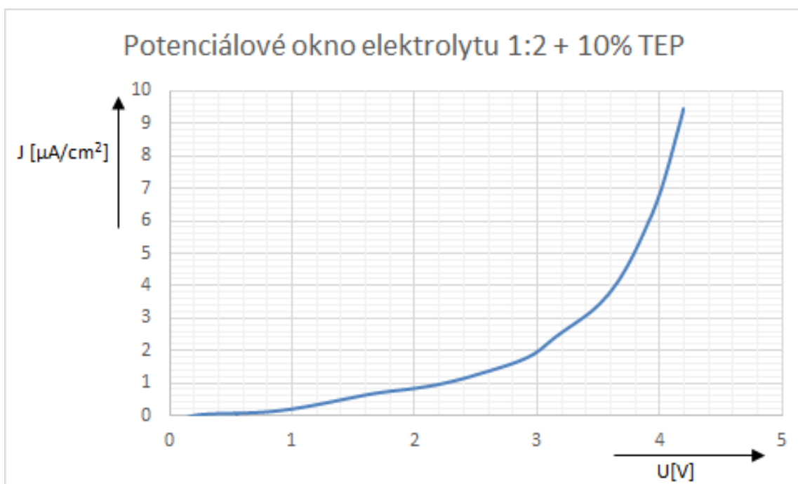
Obr. 6.19: Graf potenciálového okna vzorku 1:2 s 10% retardéru hoření TEP.
