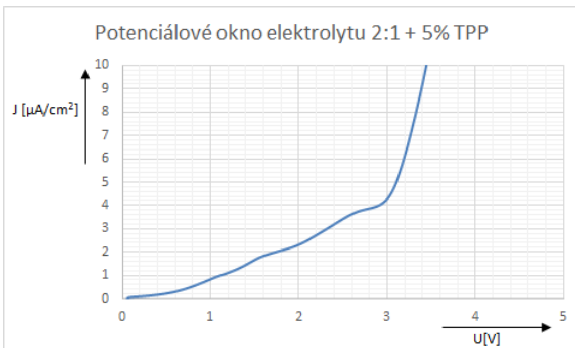
Obr. 6.23: Graf potenciálového okna vzorku 2:1 s 5% retardéru hoření TPP.
