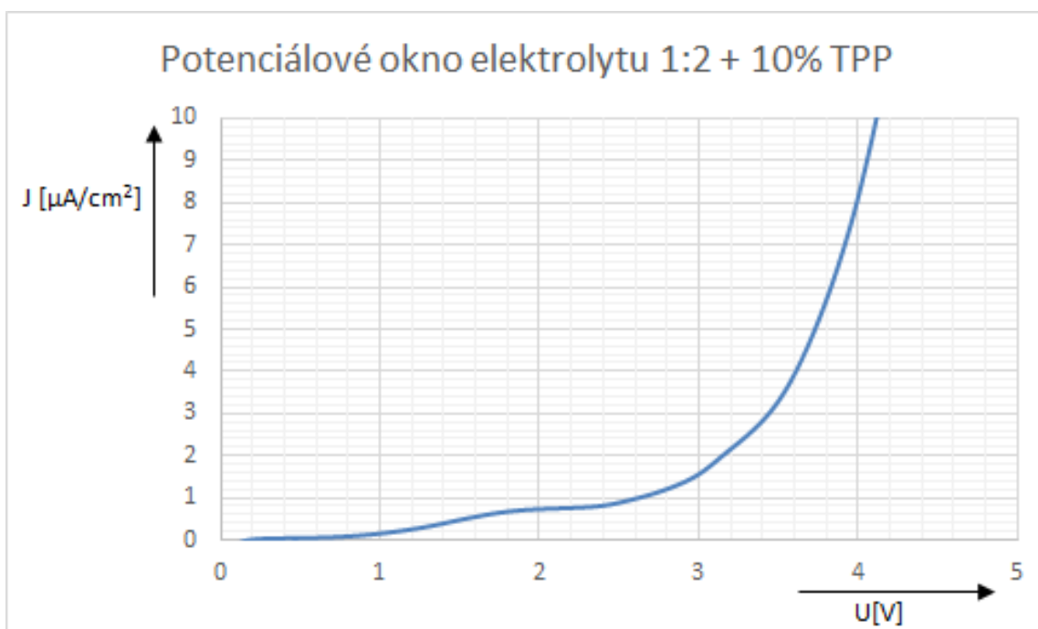
Obr. 6.25: Graf potenciálového okna vzorku 1:2 s 10% retardéru hoření TPP.
