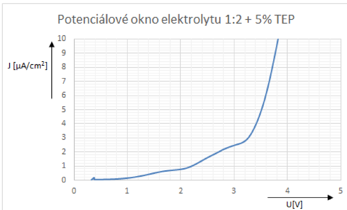
Obr. 6.16: Graf potenciálového okna vzorku 1:2 s 5% retardéru hoření TEP.
