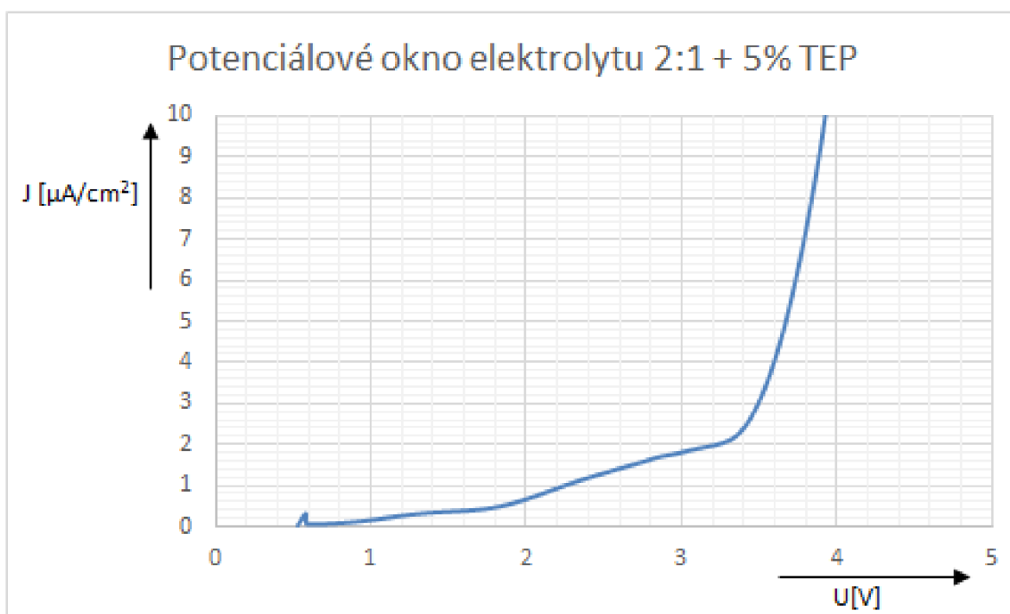
Obr. 6.17: Graf potenciálového okna vzorku 2:1 s 5% retardéru hoření TEP.
