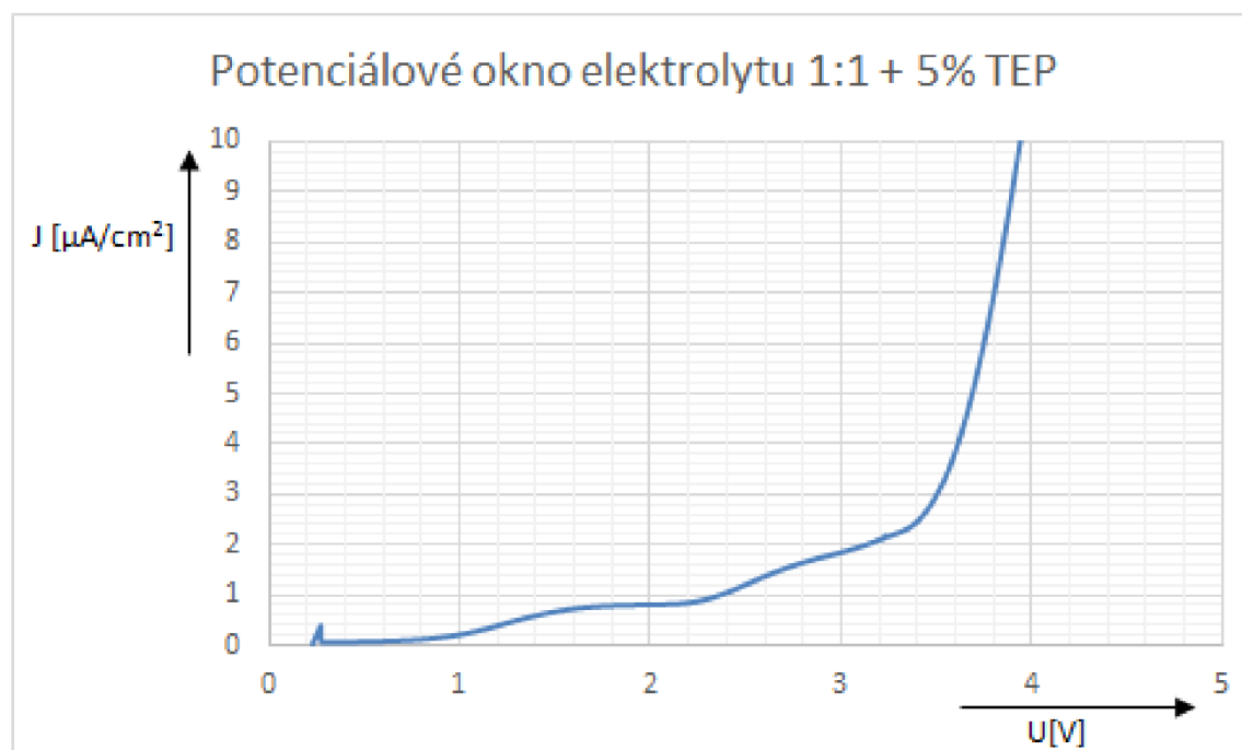
Obr. 6.15: Graf potenciálového okna vzorku 1:1 s 5% retardéru hoření TEP.
