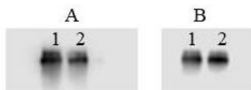
Obr. 29: Optimalizace ředění sekundární anti-králičí protilátky pro chemiluminiscenční detekci alkalickou fosfatasou. Ředění protilátky A – 1:5000; B – 1:10000. Jako vzorek je na membránách zobrazen 1 – hymenoptaecin kaplovaný na BSA (2 ng); 2 – hymenoptaecin kaplovaný na BSA (1 ng).
