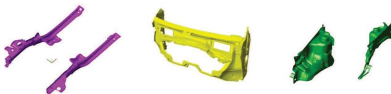
Obrázek 26- Příčný nosník, příčná stěna a podběhy
