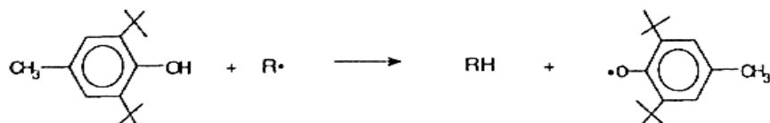
Obrázek 4: Mechanismus transferu radikálu na molekulu BHT [1]
