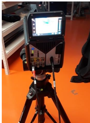
Obrázek 23: Termovizní kamera používaná pro měření
