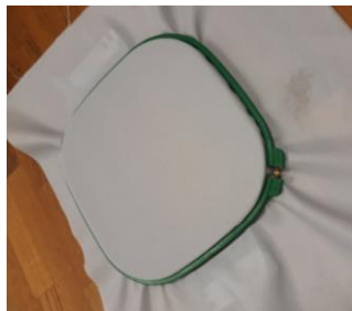
Obrázek 26: Vzorek upnutý v rámu před měřením
