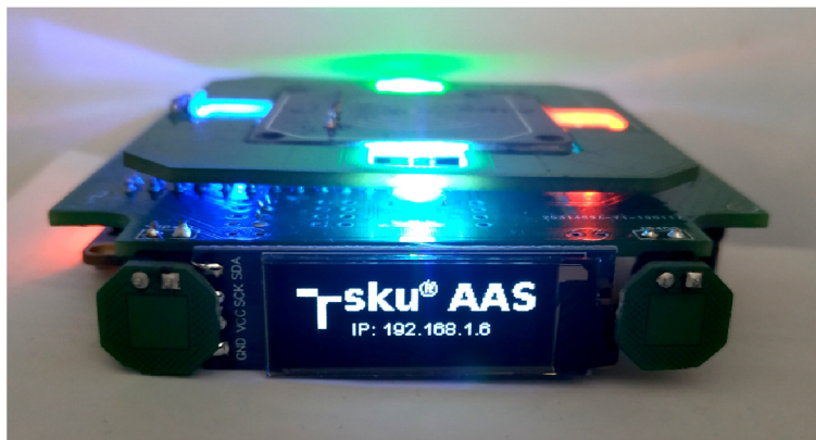
Obrázek 21 - zapnutý AAS modul s textem na displeji a rozsvícenými LED
