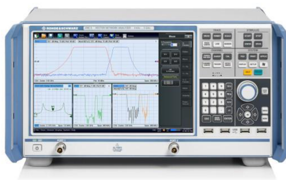
Obrázek 21: Vector Network Analyzer ZNC3 [25]
