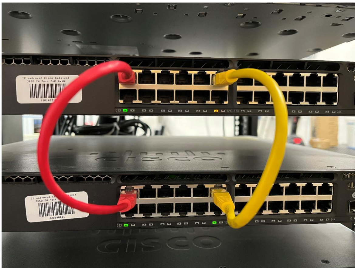
Obrázek 37: Přerušení smyčky na přepínači Cisco 3650. Zdroj: [vlastní zpracování]
