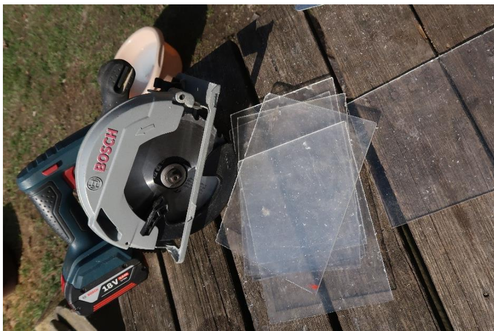
Obr.39-40.: Řezání laminátového skla
