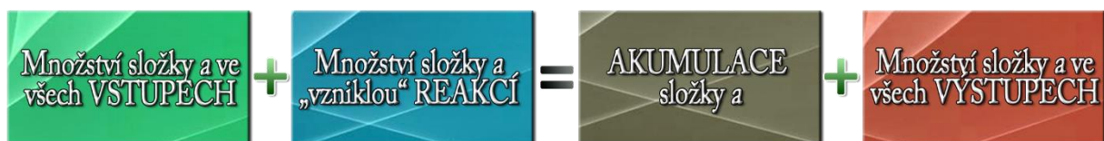
Obr. 13 Obecné vyjádření pro materiálovou bilanci reaktoru za ustáleného stavu s probíhající chemickou reakcí pro složku a
