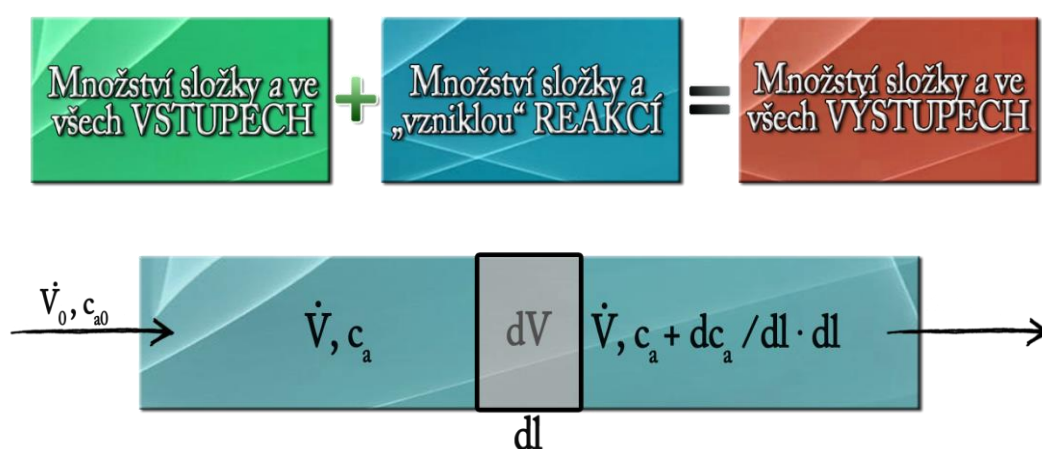
Obr. 14 Materiálová bilance pro průtočný trubkový reaktor, ve kterém nedochází k akumulaci bilancované složky a
