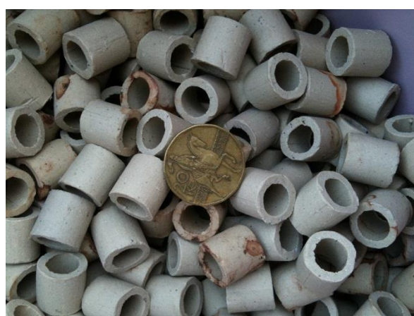
Obr. 50 Fotografie katalyzátoru (vlevo) a inertního materiálu (vpravo) po dlouhodobém testu [A9]
