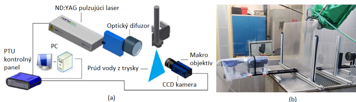
Obr. 8: Schéma merania rýchlosti a veľkosti kvapiek (a), meranie rýchlosti a veľkosti kvapiek (b)
