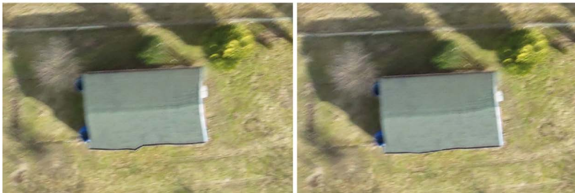
Obrázek 39 - Agisoft – nalezené nesrovnalosti (vlevo použitý DEM, vpravo Mesh model) [vlastní tvorba]
