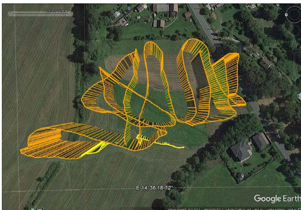
Obrázek 29 - znázornění trajektorie letu v manuálním režimu [vlastní tvorba]
