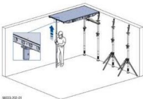
Obrázek 24: Postup montáže bednění stropu [61]
