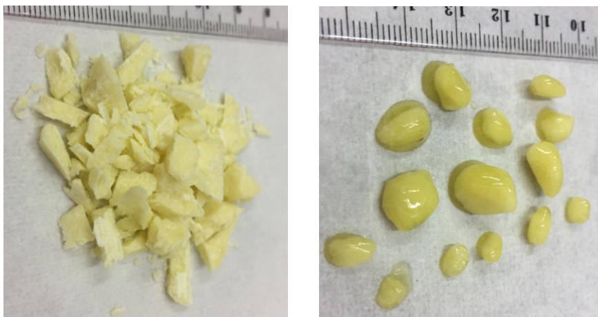
Obrázek 22. Očkující krystaly před temperací (vlevo), a po temperaci (vpravo).
