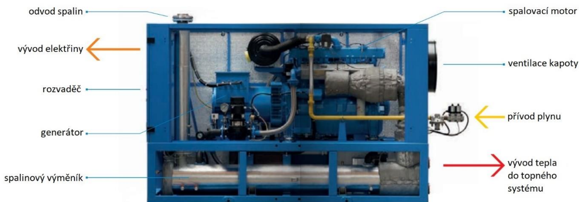
Obr. 13 – Vnitřní uspořádání kogenerační jednotky TEDOM [22]
