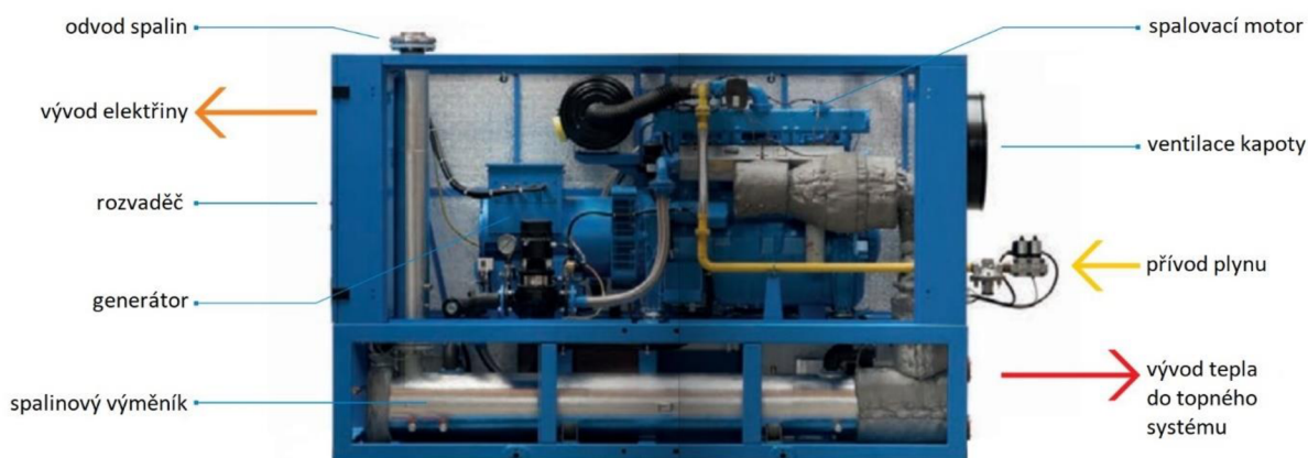
Obr. 13 – Vnitřní uspořádání kogenerační jednotky TEDOM [22]
