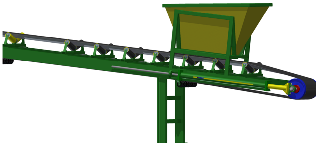
Obr. 12 pohled na celou napínací stanici
