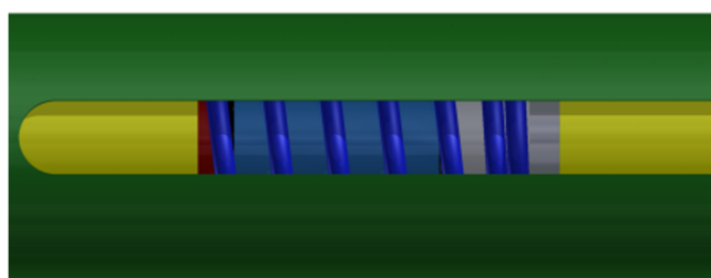
Obr. 11 signalizace nedostatečného předeptnutí, hrana trubky se dostala do červené zóny
