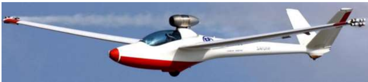
Obr. 4 Motor TJ 100 na letounu Super Salto [4]
