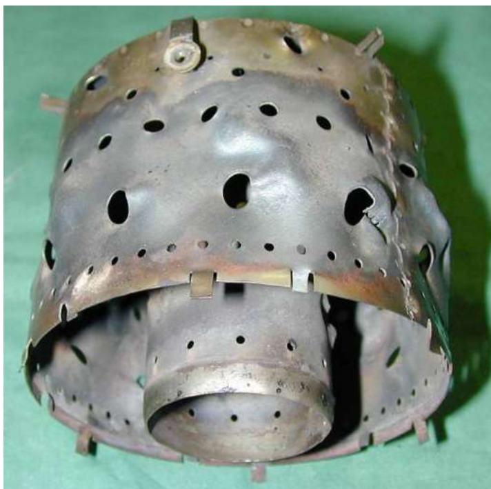
Obr. 19 Spalovací komora po poškození požárem [26]
