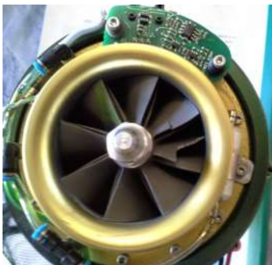
Obr. 17 Ulomená lopatka kompresoru [27]
