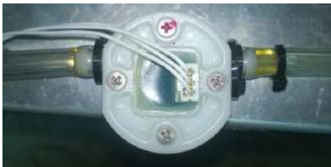
Obr. 30 Průtokoměr instalovaný na palivové soustavě motoru JetCat P80-SE [vlastní zpracování]
