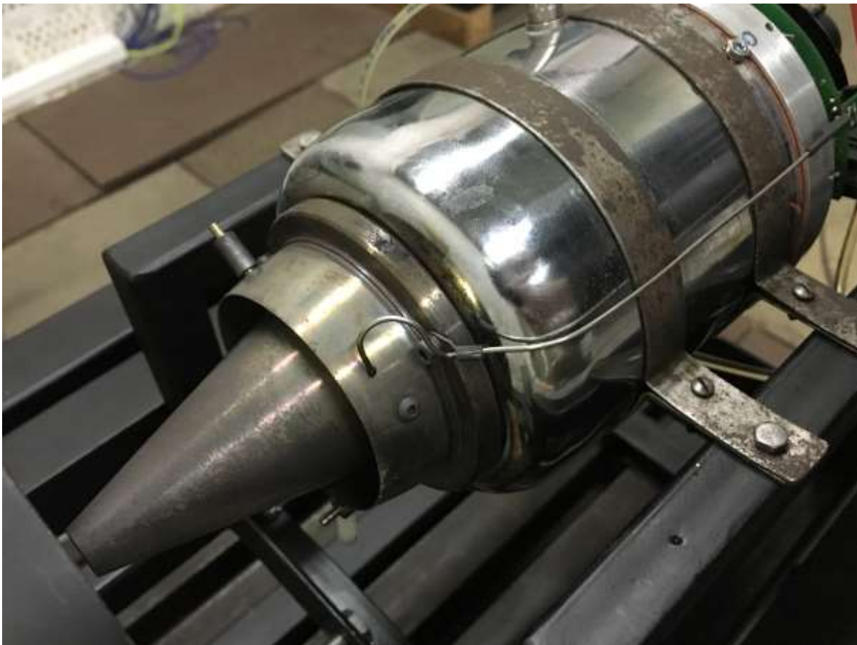
Obr. 23 Měření teploty výstupních plynů na motoru JetCat P-80-SE [vlastní zpracování]
