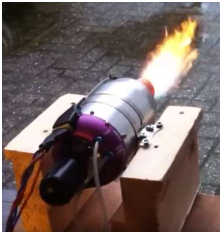
Obr. 20 Zachycení šlehání plamenů z výstupní trysky u modelu JetCat P80-SE [26]
