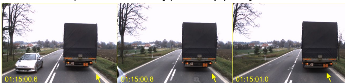
Obrázek 28 Sledování průběhu linie pomocí pevného bodu obrazovky
