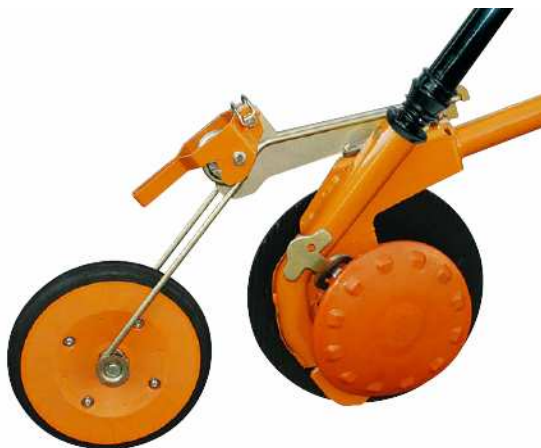
Obrázek 12. Jednokotoučová sečí botka se zavlačovacím kolečkem ( http://www.amazone.de )
