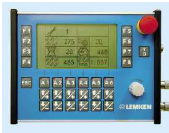
Obrázek 15. Elektronické nastavení výsevu ( http://www.lemken.de )
