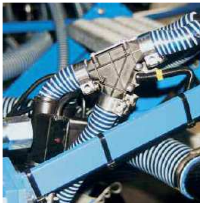
Obrázek 17. Mechanismus vracející osivo zpět do zásobníku ( http://www.lemken.de )
