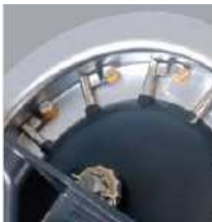
Obrázek 8. Lžičkové výsevní ústrojí Horsch ( http://www.horsch.com )
