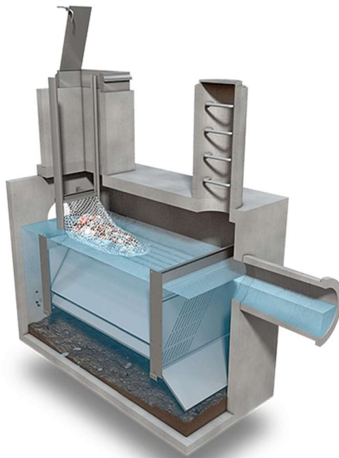
Obrázek 21, 22: příklady záchytných sítí ( Storm Water Systems, Inc. 2023 )
