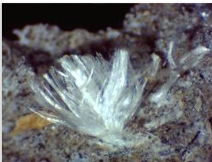
Obrázek 2: Chryzotilová vlákna v azbestocementové desce (autor 2020)
