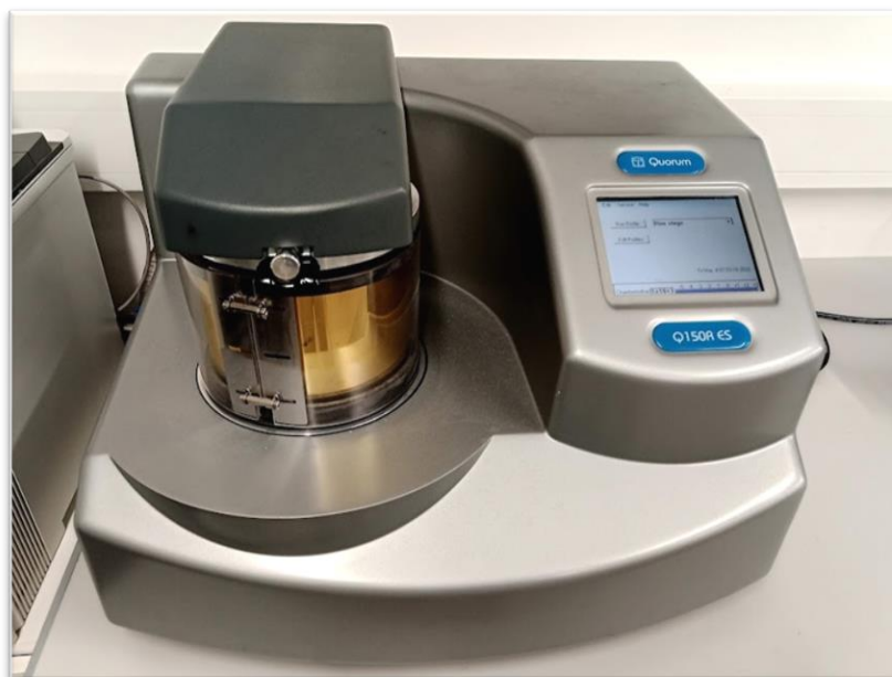
Obrázek 48: Naprašovačka kovů Quorum Q150R ES P (autor)
