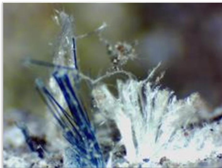
Obrázek 8: Vlákna krokydolitů a chryzotilu v azbestocementové desce (autor)
