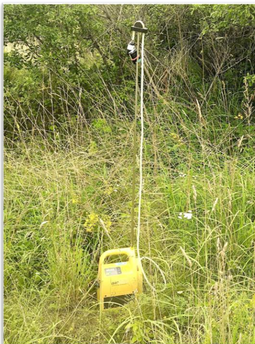
Obrázek 41: Umístění stacionárního čerpadla v terénu (autor)
