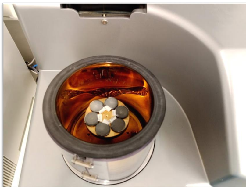
Obrázek 49: Umístění vzorků v naprašovačce kovů Quorum Q150R ES P (autor)
