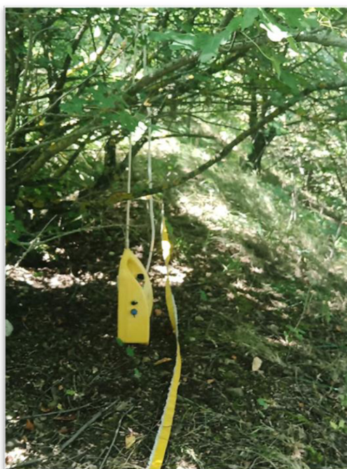
Obrázek 30: Umístění odběrového čerpadla na hranici kamenolomu Sýkořice (autor)
