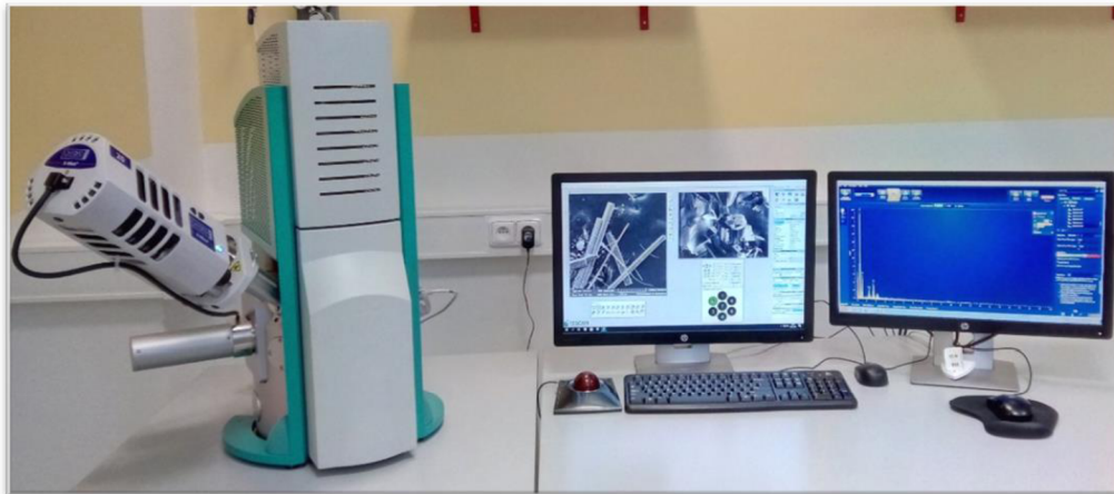
Obrázek 46: Elektronový mikroskop TESCAN VEGA 3 s EDX detektorem (autor)
