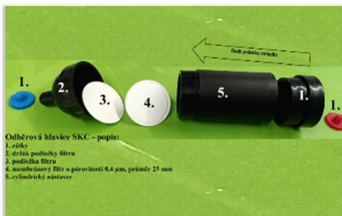
Obrázek 45: Odběrová hlavice SKC s MCE filtrem pro odběr vzdušnin (autor)
