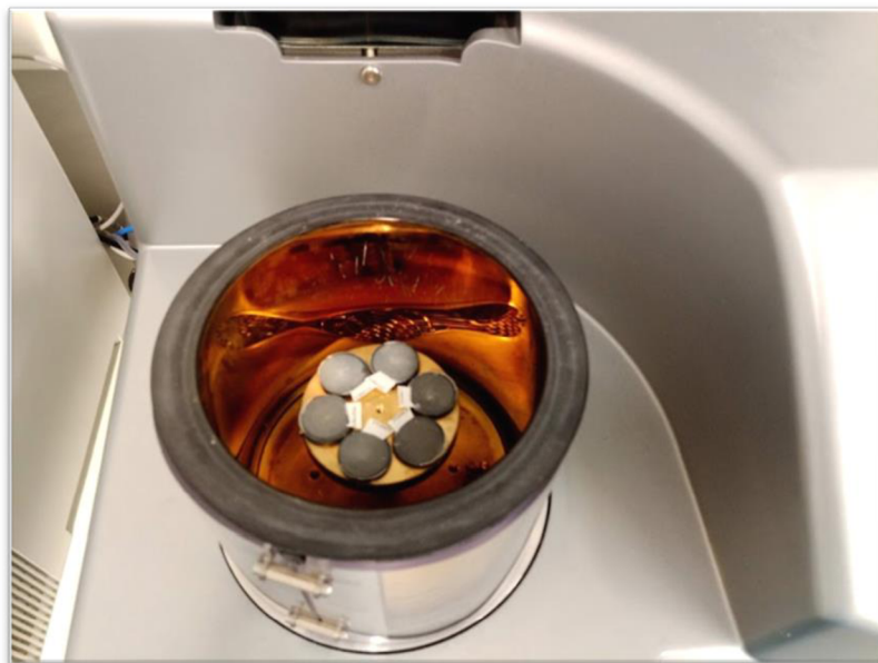
Obrázek 49: Umístění vzorků v naprašovačce kovů Quorum Q150R ES P (autor)
