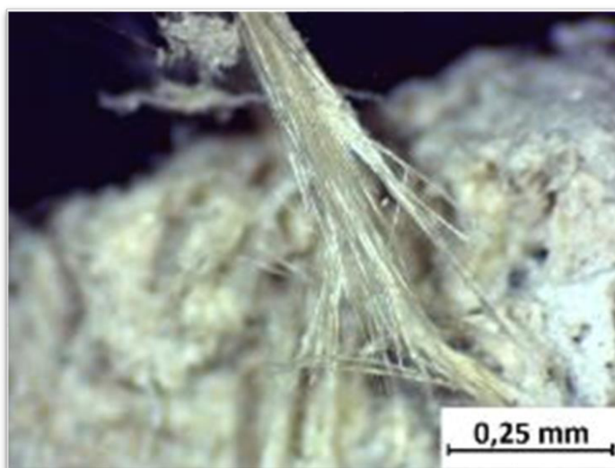
Obrázek 4: Amosit v azbestocementové desce (autor)
