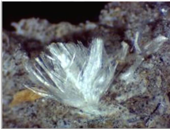
Obrázek 2: Chryzotilová vlákna v azbestocementové desce (autor 2020)
