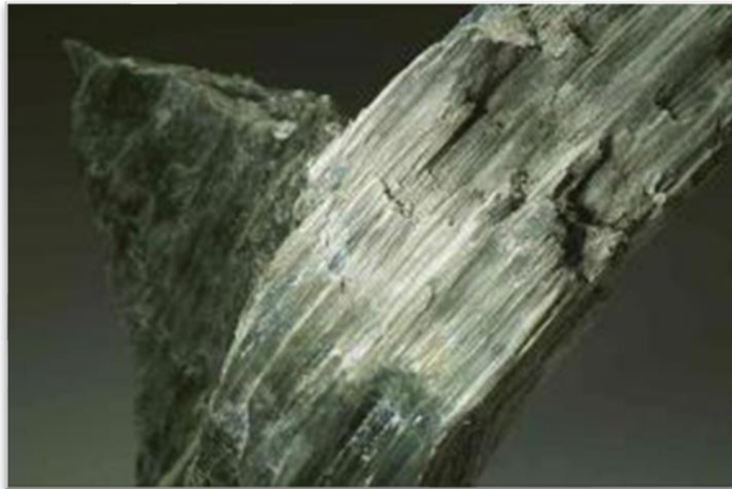
Obrázek 1: Vlákenný chryzotil s typickým hedvábným leskem (Jirásek, Vavro 2008)
