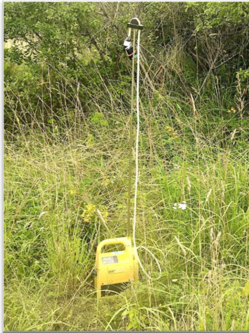
Obrázek 41: Umístění stacionárního čerpadla v terénu (autor)
