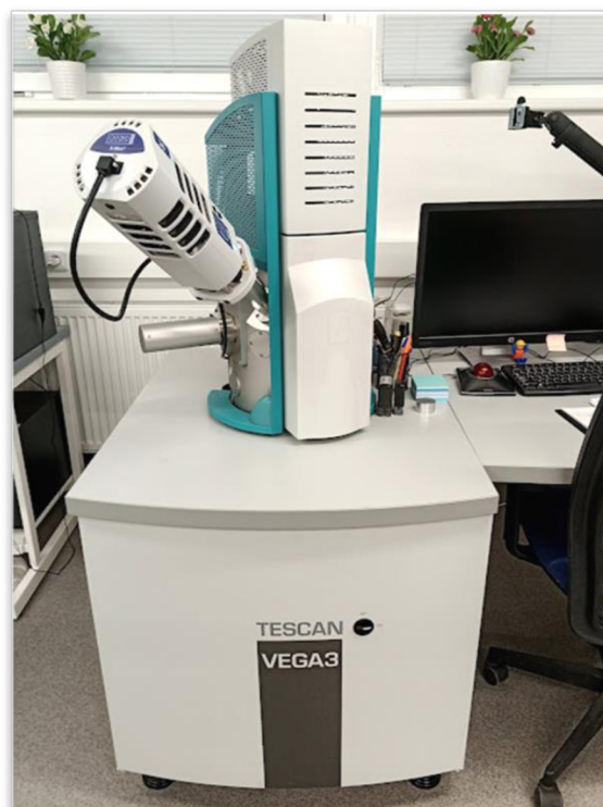
Obrázek 47: Elektronový mikroskop TESCAN VEGA 3 s EDX detektorem (autor)
