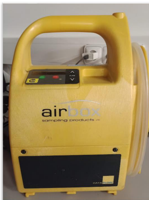
Obrázek 40: Stacionární čerpadlo Airbox (autor)
