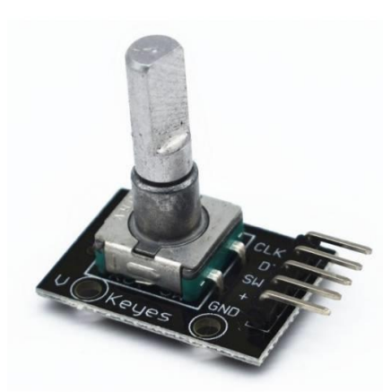
Obrázek 8: Rotační kodér, převzato z [13].
