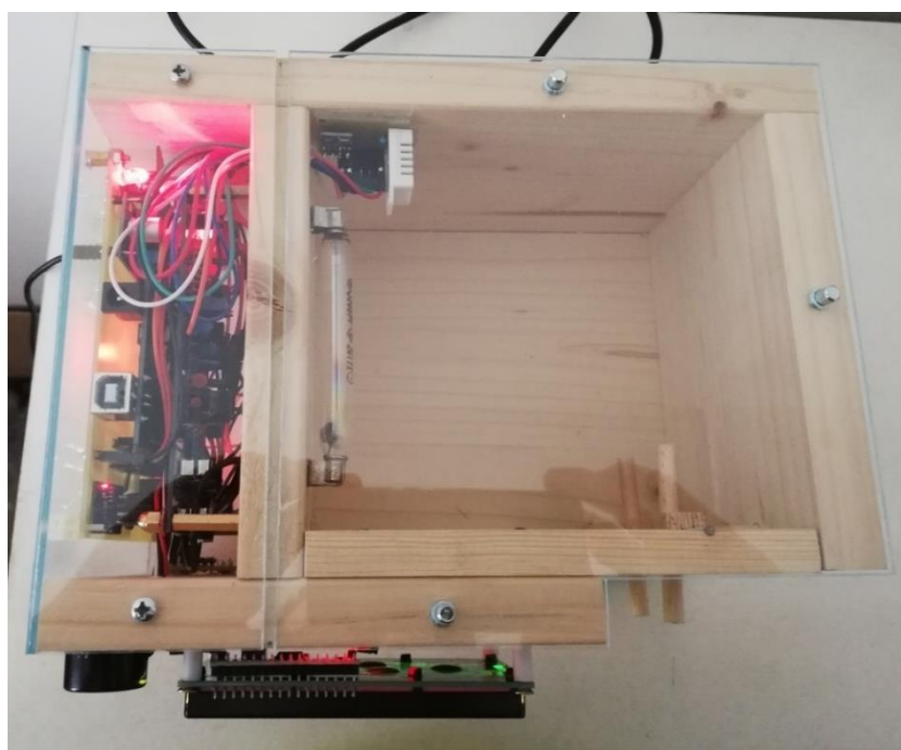
Obrázek 28: Detail GM detektoru a čidel DHT22, BMP180 v maketě místnosti, vlastní tvorba.
