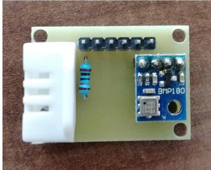
Obrázek 25: Druhá osazená deska plošného spoje s čidly DHT22 a BMP180, vlastní tvorba.
