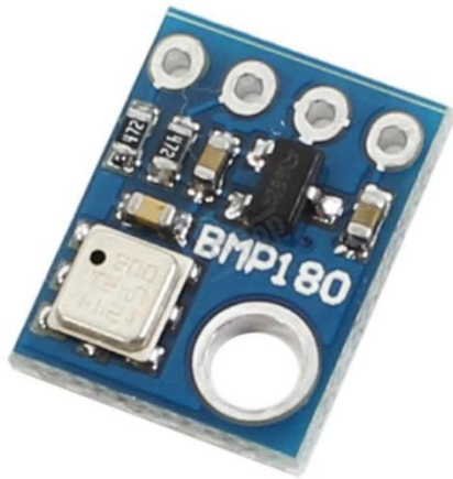
Obrázek 7: Čidlo BMP180, převzato z [11].
