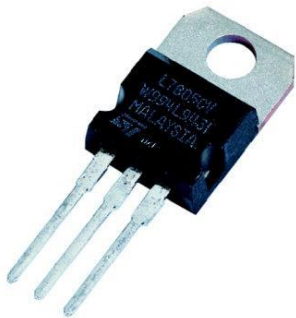
Obrázek 12: Stabilizátor napětí 7805CV, převzato z [17].
