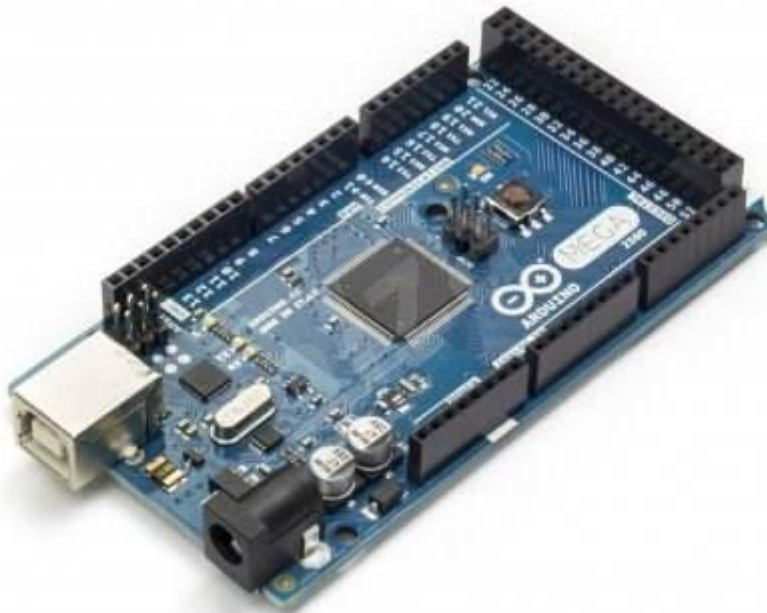
Obrázek 4: Arduino Mega2560, převzato z [7].
