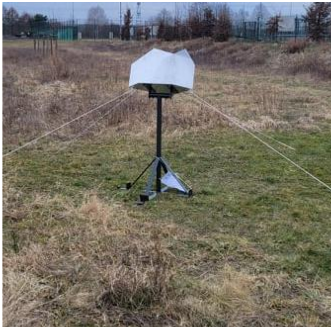
Obr. 15: Sestavený celý pětiúhelníkový odražeč na místě
