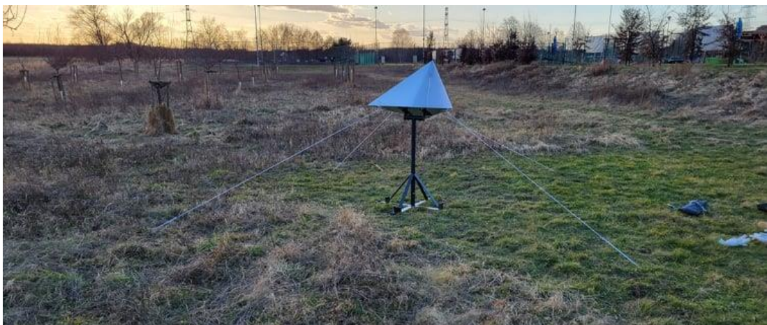
Obr. 14: Sestavený celý trojúhelníkový odražeč na místě
