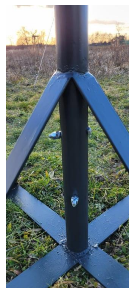
Obr. 7 a 8: Detail stojanu odražeče s upevňujícími prvky a upevnění vnitřní trubky
