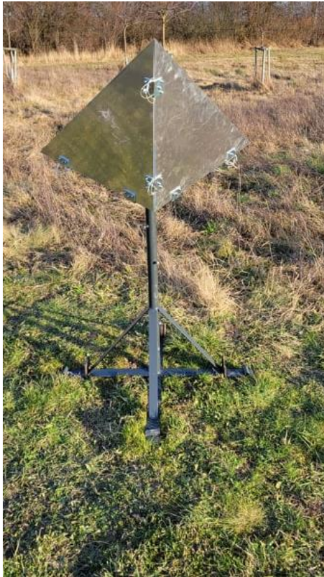
Obr. 12 a 13: Ukázky sestavených odražečů, postavených na stojanu a jejich spojů a upevnění.
