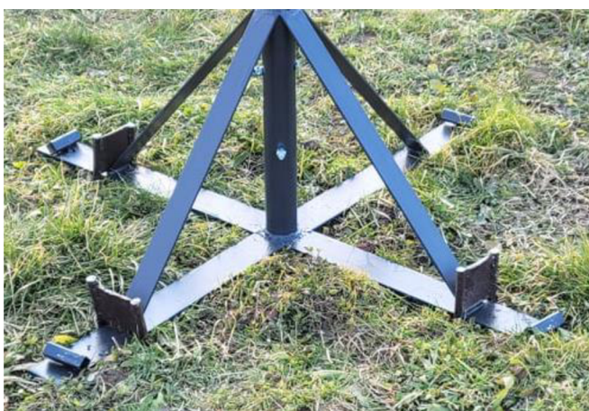
Obr. 7 a 8: Detail stojanu odražeče s upevňujícími prvky a upevnění vnitřní trubky
