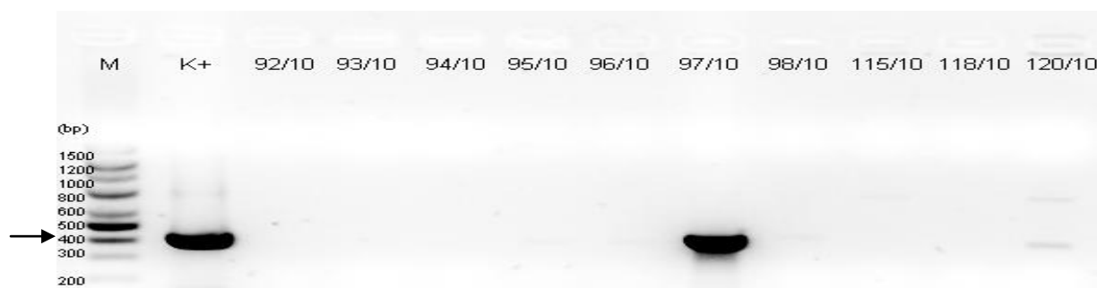
Obr. 2: Elektroforetogram zobrazující detekci genů pvl pomocí PCR u izolátu 97/10 S. aureus .
