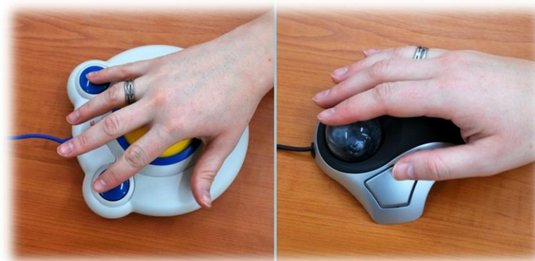
Obrázek 9: Speciální trackbally usnadňující ovládání počítače
