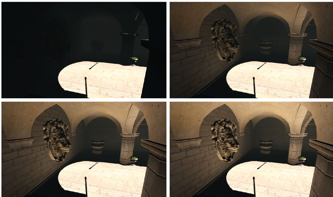
Obrázek 8.4: Ukázka metody LPV. Vlevo nahoře: pouze lokální osvětlení se stíny, ostatní: globální osvětlení počítané metodou GS sběru, počet propagací: 0, 2, 8. Počet VPL: 128^2 , velikost LPV: 32^3 , počet LPV kaskád: 4.
