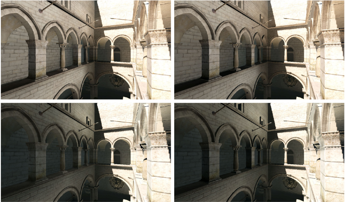
Obrázek 8.5: Porovnání jednotlivých implementací LPV. Nahoře: GS varianta, dole: CS varianta, vlevo: sběr, vpravo rozptyl. Počet VPL: 128^2 , velikost LPV: 32^3 , počet propagací: 8, počet LPV kaskád: 4.
