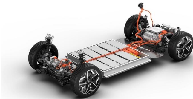
Obr. 2.3 - Akumulátor v elektromobilu
