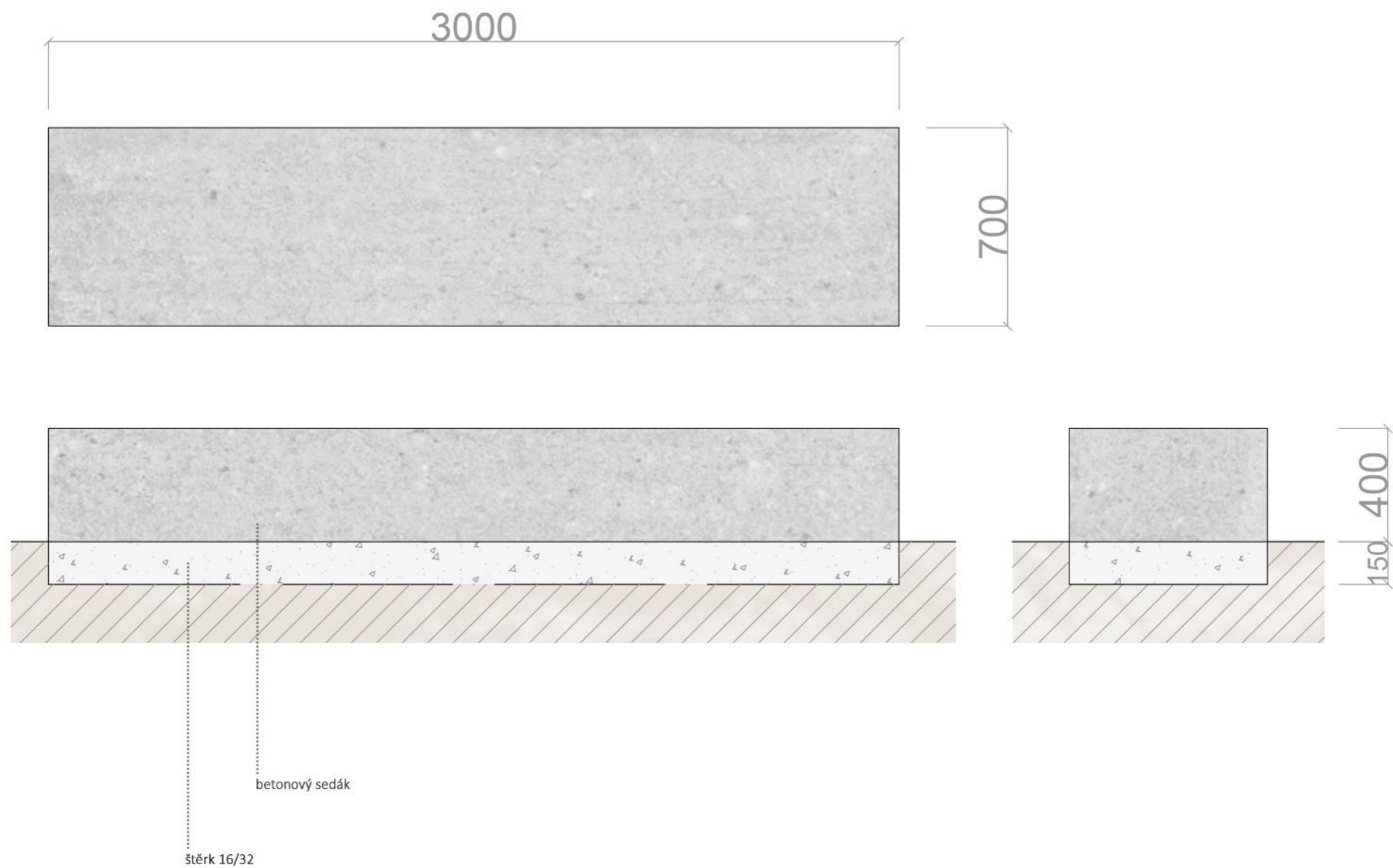
Obr.č.108: Uložení lavice na štěrkové lože (Pánková 2020)
