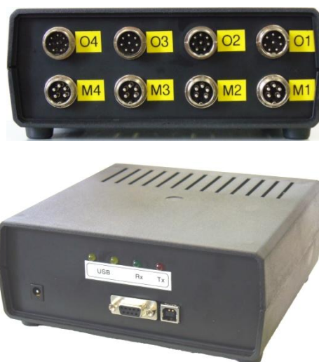
Obr. 24 Měřicí přístroje, a) optický snímač otáček; b) měřicí ústředna
