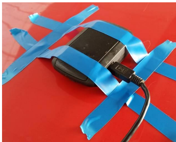
Obr. 27 Metoda GPS, a) traktor na měřeném úseku; b) umístění GPS přijímače na karoserii
