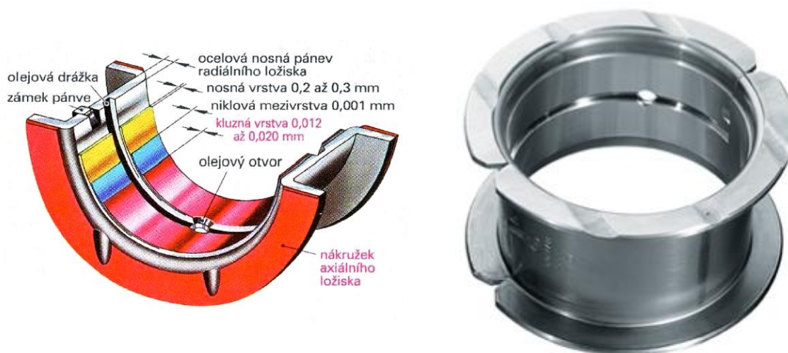
Obr. 9 Kluzné ložisko, a) schéma kluzného ložiska; b) pohled z boku
