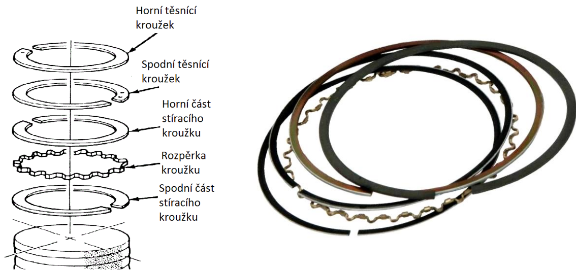
Obr. 3 Pístní kroužky, a) schéma sestavení; b) části pístních kroužků
