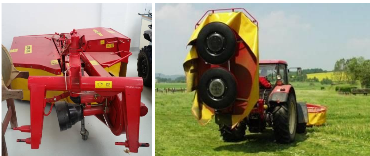
Obr. 26 Bubnový rotační žací stroj, a) pohled na pohybové ústrojí; b) pohled ze spodu
