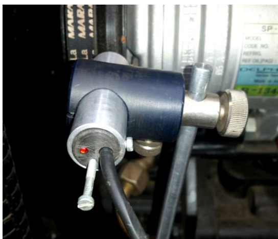
Obr. 24 Měřicí přístroje, a) optický snímač otáček; b) měřicí ústředna
