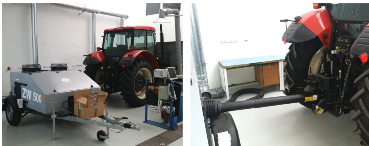
Obr. 21 Metoda měření dynamometrem, a) traktor spojený s dynamometrem; b) kardanový hřídel
