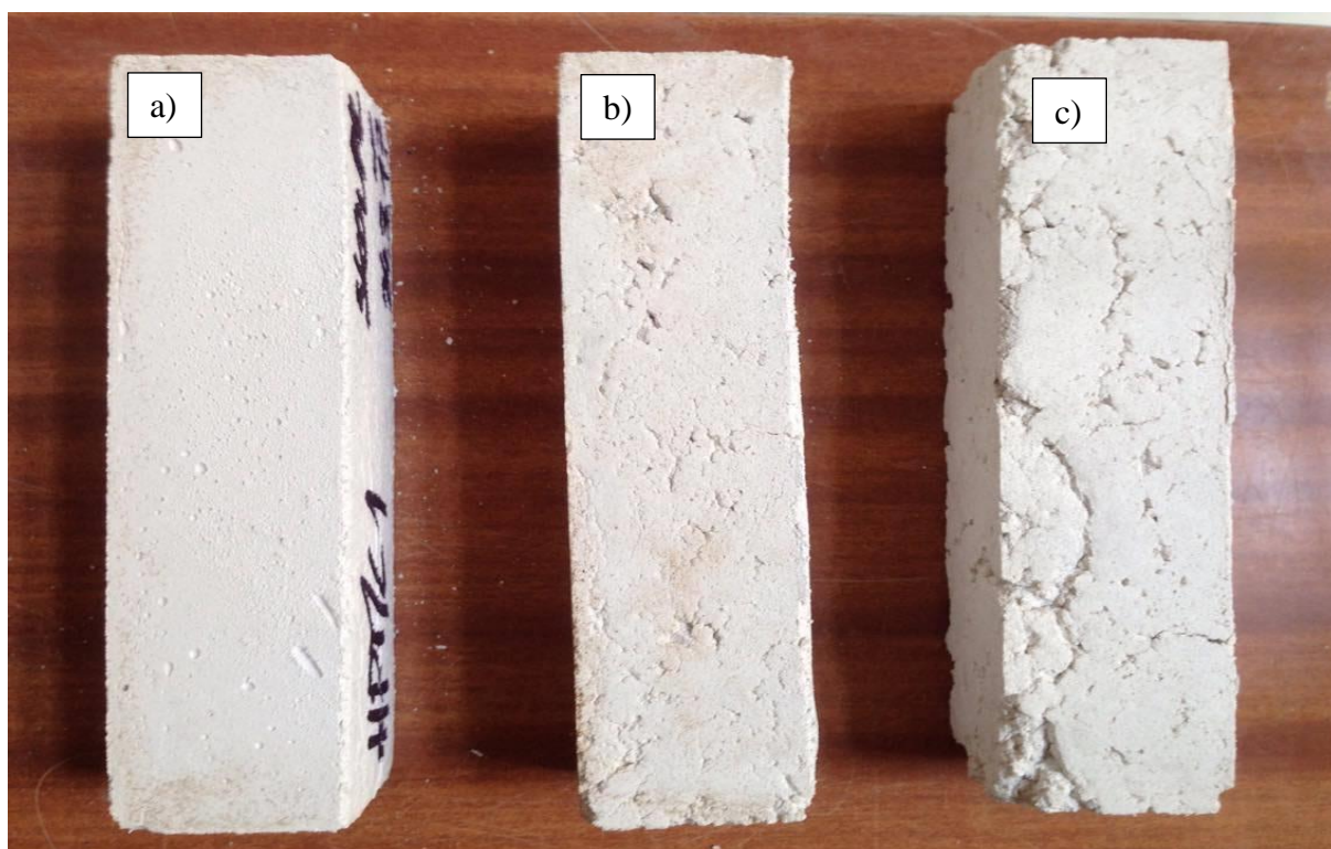
Obrázek 24: Vzorek HPMC, důvod možného poklesu pevností se zvyšující se dávkou etheru
