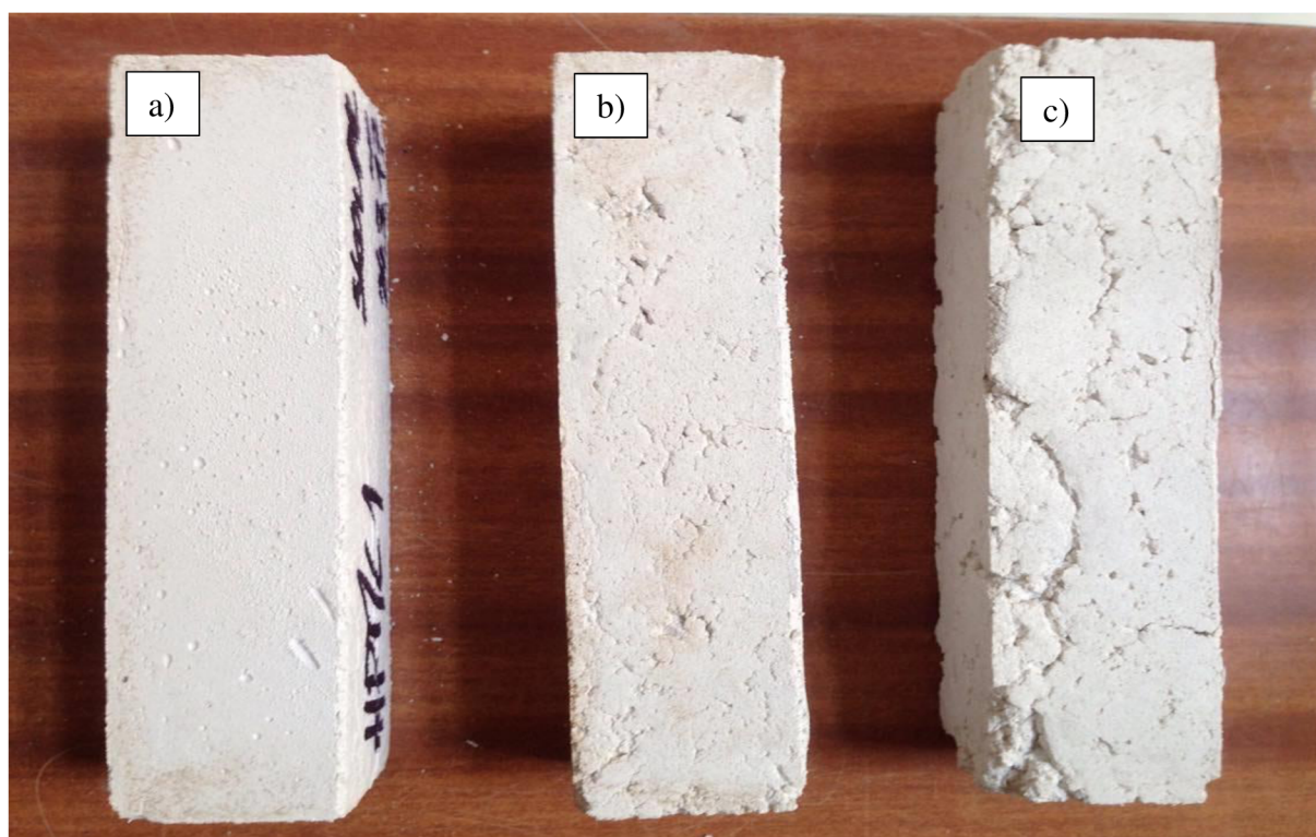
Obrázek 24: Vzorek HPMC, důvod možného poklesu pevností se zvyšující se dávkou etheru a) dávka 0,1 g, b) dávka 0,5 g, c) dávka 1 g
