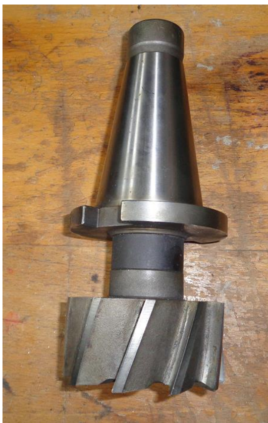
Obr. 1.5 Upínací kužel ISO pro ruční výměnu.
