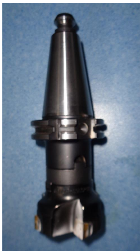
Obr. 1.6 Upínací kužel ISO pro strojní výměnu.
