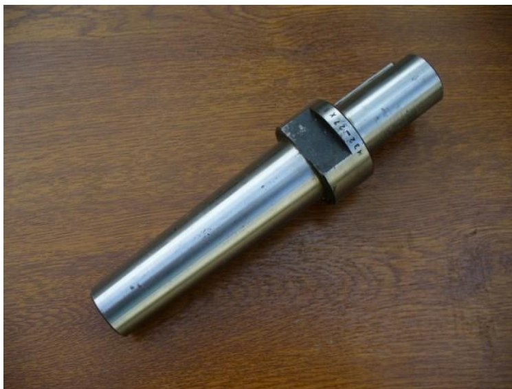
Obr. 1.3 Frézovací trn s metrickým kuželem [4].
