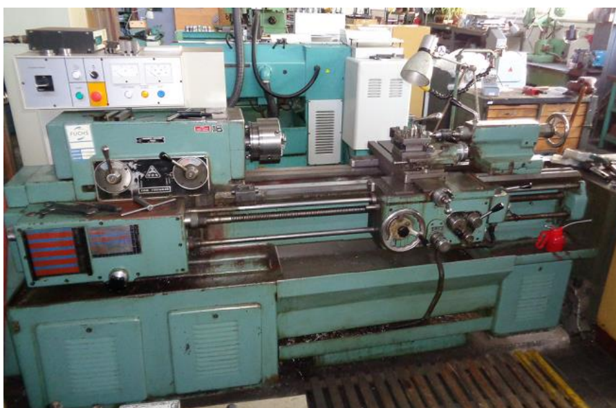
Obr. 3.7 Univerzální hrotový soustruh SV 18 RD.
