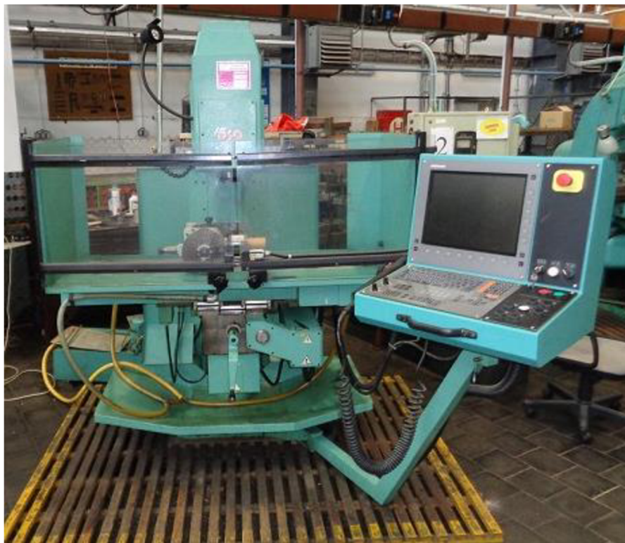
Obr. 3.8 CNC frézka FV 25 CNC A.
