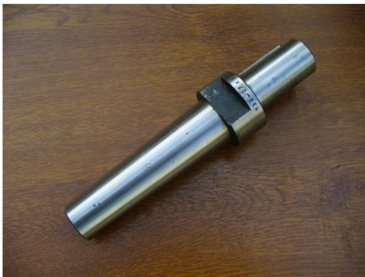
Obr. 1.3 Frézovací trn s metrickým kuželem [4].
