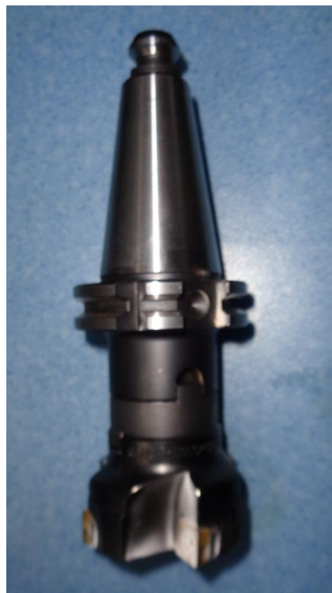
Obr. 1.6 Upínací kužel ISO pro strojní výměnu.
