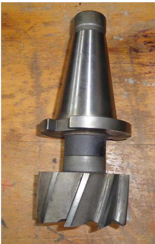
Obr. 1.5 Upínací kužel ISO pro ruční výměnu.
