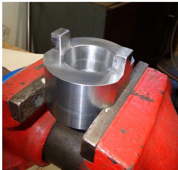
Obr. 6.2 Nově navržený přípravek.
