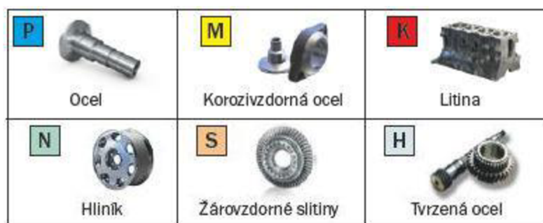
Obr. 2.1 Skupiny obráběných materiálů [9].
