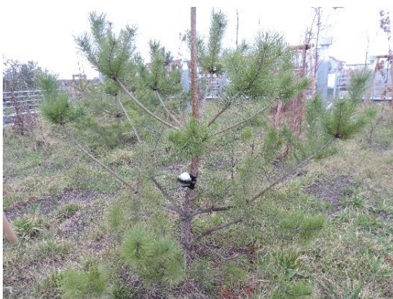
Obrázek 2 Dendrometr nainstalovaný na střeše budovy High-tech technologicko-výukového pavilonu FLD
