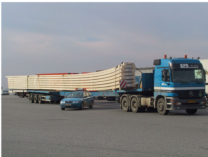
Obrázek 10.5 Jízdní souprava s technickým doprovodem [23]
