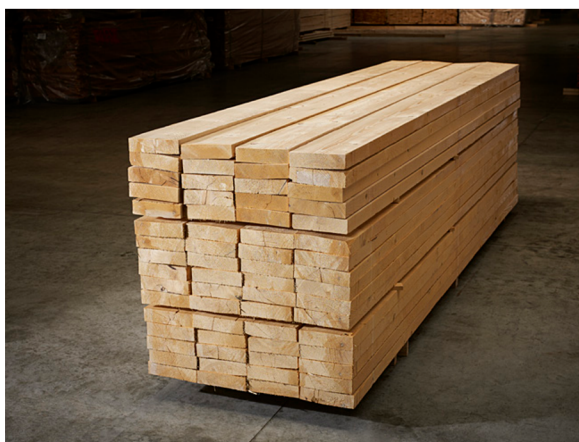
Obrázek 10.3 Smrkové řezivo Třídy C24 [21]
