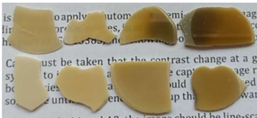
Obr. 32 Vzorky SC s rostoucím obsahem TiO_2 (zleva od 0,1- 0,5 at.% TiO_2 ) s předslinovacím režimem 1300 °C/ 120 min (horní řada) a 1560 °C/2 min (dolní řada) s následným izostatickým lisováním za tepla při maximální teplotě 1400 °C, výdrž 4 hodiny a maximálním tlakem 200 MPa
