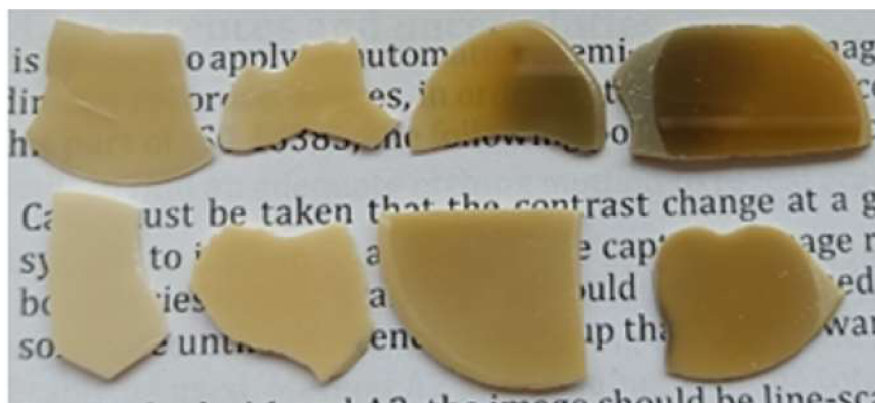
Obr. 32 Vzorky SC s rostoucím obsahem TiO_2 (zleva od 0,1- 0,5 at.% TiO_2 ) s předslinovacím režimem 1300 °C/ 120 min (horní řada) a 1560 °C/2 min (dolní řada) s následným izostatickým lisováním za tepla při maximální teplotě 1400 °C, výdrž 4 hodiny a maximálním tlakem 200 MPa
