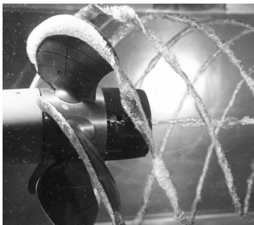
Obr. 2.6a Vznik kavitačních činitelů [16]
