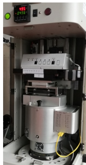
Obr. 3.11 Přístroj CETR UMI Multi-Specimen Test System – Tribometr
