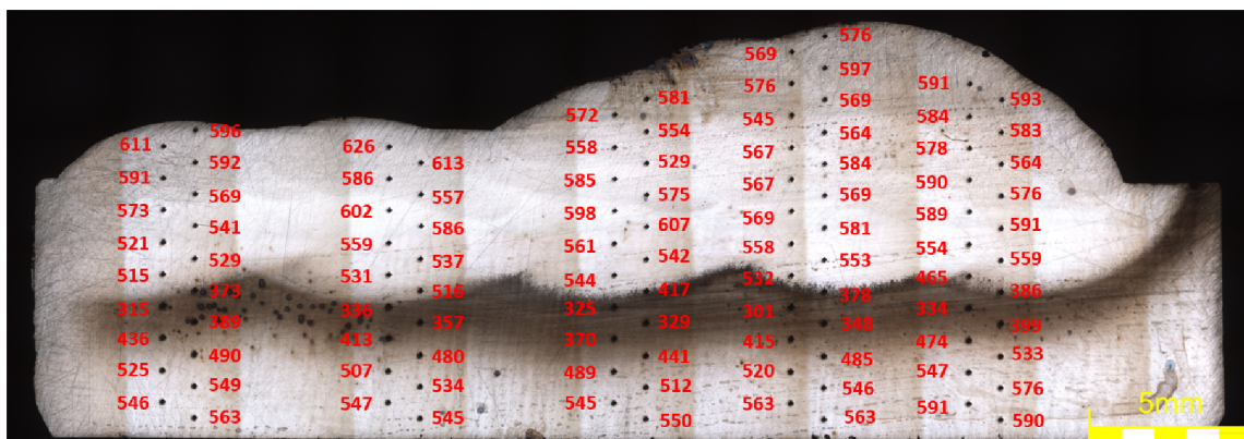
Obr. 3.3 Naměřené tvrdosti v příčném řezu návaru – stav po navaření ( Cronitex Rc 44) Teplota předehřevu při navařování: cca 320 °C
