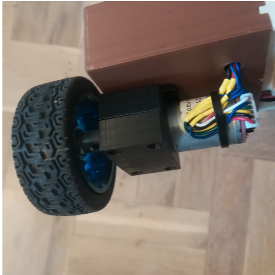
Obrázek 1.4: Kompaktní sada motoru JGA25-370 a kola robota
