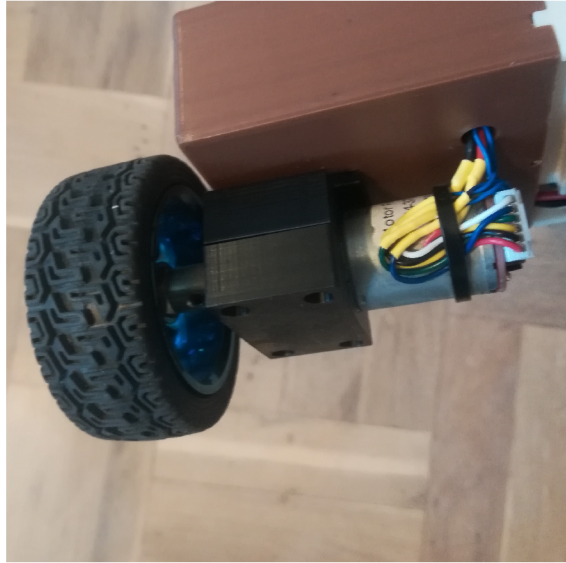
Obrázek 1.4: Kompaktní sada motoru JGA25-370 a kola robota
