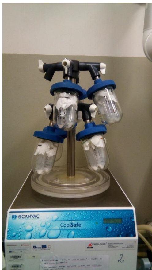
Příloha 21 – Lyofilizace na přístroji SANVAC COOLSAFE 110 – 4 PRO a vážení sušiny jedu.
