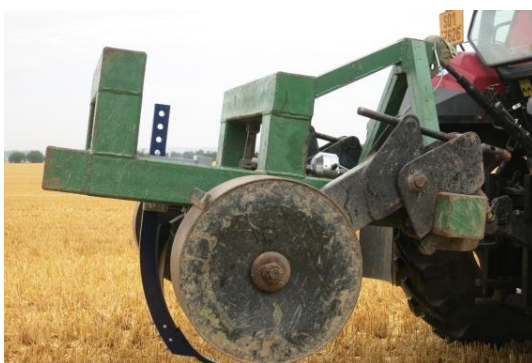
Obr. 37 Měřicí rám byl upevněn v třibodovém závěsu traktoru, opěrná kola slouží k nastavení zahloubení radličky; foto autor
