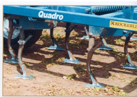
Obr. 16 Šípovité podřezávací radličky radličkového kypřiče (Hůla a kol., 2007)
