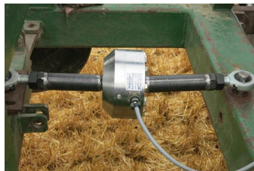
Obr. 36 Uchycení dynamometru mezi vnějším a vnitřním rámem; foto autor
