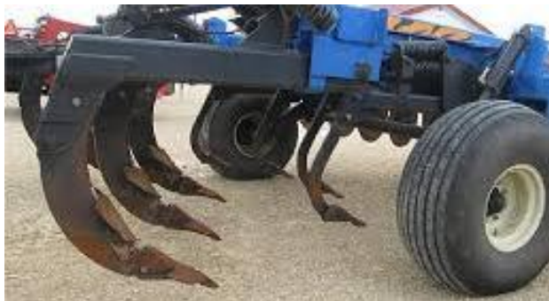
Obr. 26 Stroj pro postupné kypření do narůstající hloubky (Anonym 4)
