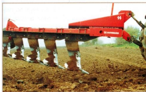
Obr. 25 Dlátový kypřič použitelný pro narušení zhutnělé vrstvy v půdním profilu – seřiditelný úhel sklonu křídel umožňuje zvolit intenzitu kypření (Hůla a kol., 2008a)
