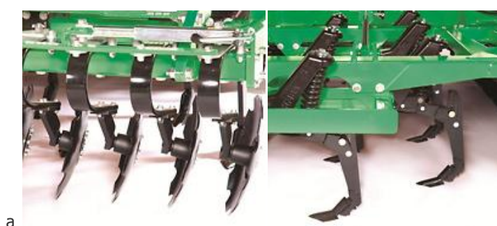
Obr. 24 Kombinátor SIMBA SL - detaily; a – talíře, b – slupice (Anonym 9, 2016)
