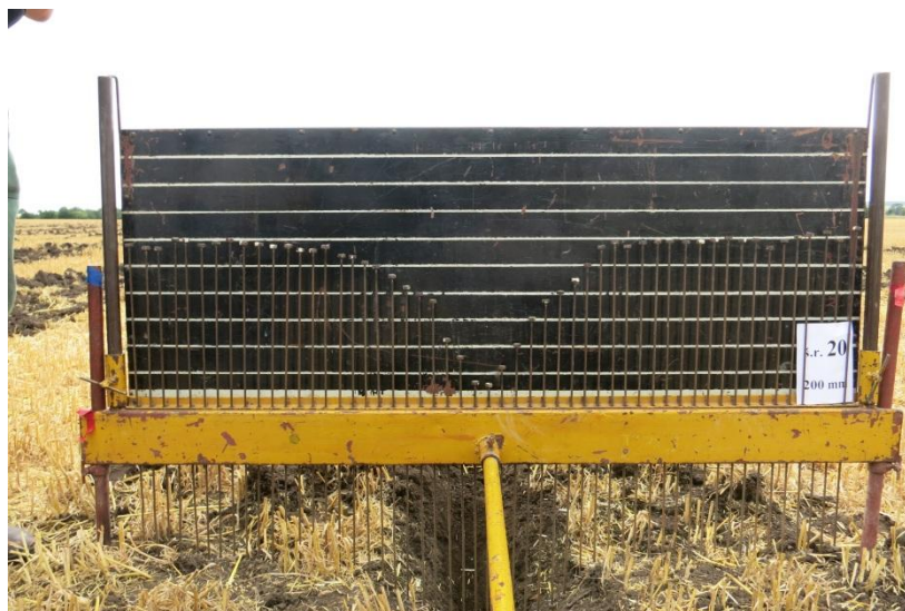
Obr. 39 Profilograf konstrukce VÚZT Praha-Ruzyně při polním měření; foto autor
