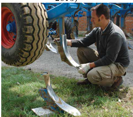
Obr. 19 Změna hloubky u nesené varianty intenzivního kypřiče Karat (Anonym 8, 2016)
