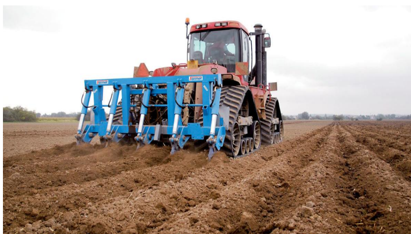
Obr. 27 Hloubkový kypřič Krtek při práci na poli (Anonym 5, 2016)
