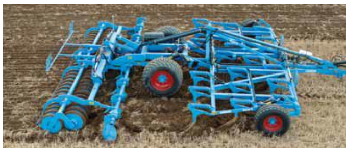
Obr. 21 Návěsný intenzivní kypřič Karat (Anonym 8, 2016)
